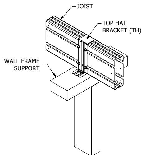
JOIST OVER SUPPORT FRAME CONNECTION
